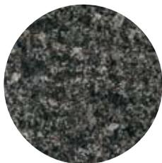
**Ecotar-A** для очистки воды от растворенного железа, комплексных железоорганических соединений, марганца, солей жесткости. Рекомендуется для очистки воды из колодцев и неглубоких скважин. Визуальная оценка исходной воды: вода имеет желто-бурю окраску, при отстаивании образуется осадок.
