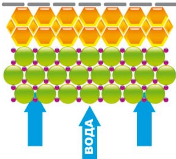
Поток воды при регенерации
