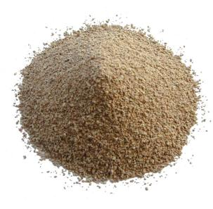
${\bf M}{\bf W}{\bf \Phi}$  – пористый материал, состоящий, в первую очередь, из смеси оксидов и карбонатов кальция и магния, оксидов алюминия и кремния. В его порах каталитически закреплен активный компонент – диоксид марганца, равномерно распределенный ПО объему зерна. Равномерность распределения по объему гранулы каталитически активного компонента обеспечивает стабильность работы материала при длительной эксплуатации, поскольку при истирании гранул химический состав поверхности не изменяется.
