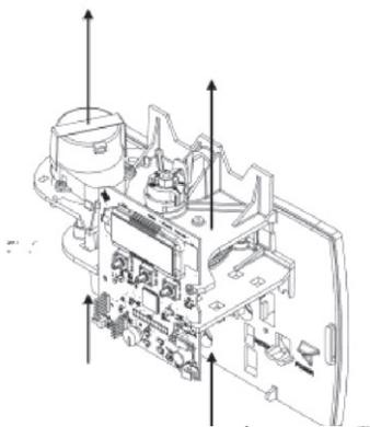
**Рис. 3.** Потянуть на блок главного привода вверх, чтобы освободить его.
